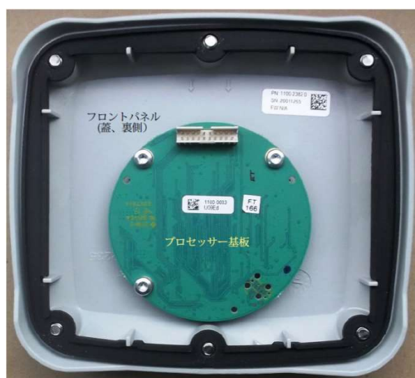
プロセッサ基板と蓋(フロントカバー、内側)
